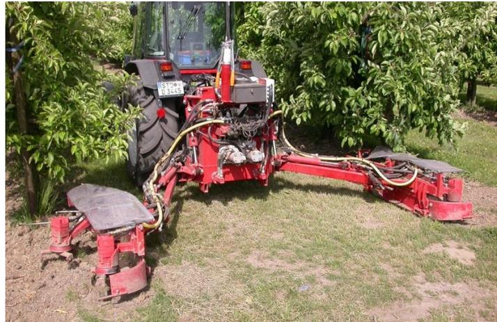
Abb. 3.10: Ladurner Krümler: Kreiselkrümler doppelseitig mit je zwei Krümlerwerkzeugen (Zwischenbaumbereich & Baumstreifen) mit automatischem Taster. (Foto: Esteburg 2017)
