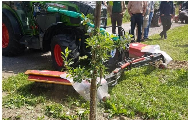
Abbildung 3.11: Vimas Öko-Cleaner: Faden-Rotormäher zum Abmähen des Aufwuchses im Baumstreifen (Foto: ÖON, 2018)
