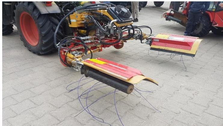
Abb. 2.4: Faden-Rotormäher der Fa. Seppi (Foto: 2018, Oeser)
